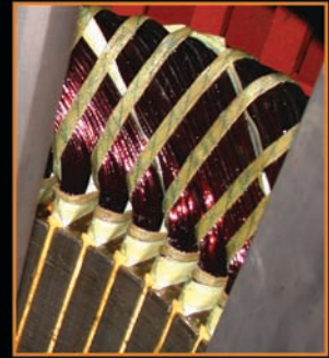
Nessun collegamento tra avvolgimenti internamente alla macchina
